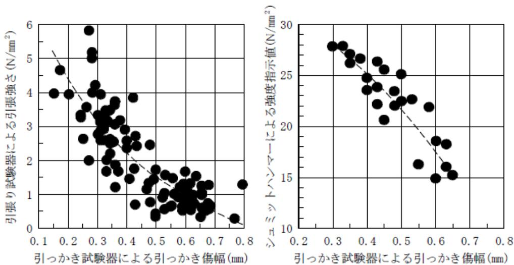
付図4 引張り試験機、シュミットハンマーと引っかけ試験器による測定結果の関係<sup>4),5)</sup>
