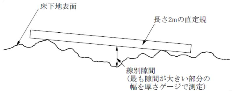
図2 凹凸の測定方法
