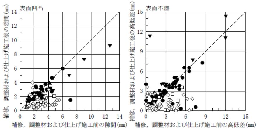
付図2 補修、調整材および仕上げ施工前と施工後の隙間、高低差の関係
